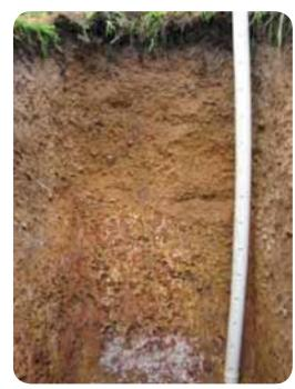
PHOTO 1: TYPICAL GRAVEL SOIL PROFILE
